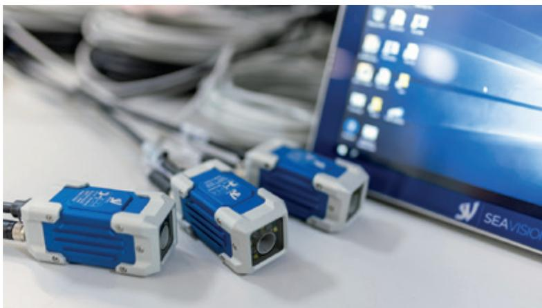
Un sistema di visione tradizionale, dotato di microcamere e di software proprietario
