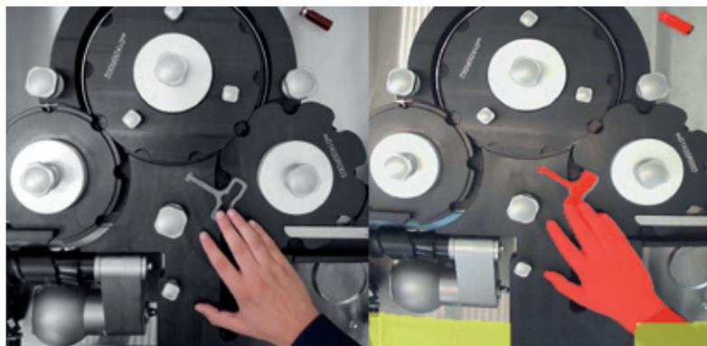
Esempio di immagine acquisita e analizzata dal sistema di visione con Intelligenza Artificiale
